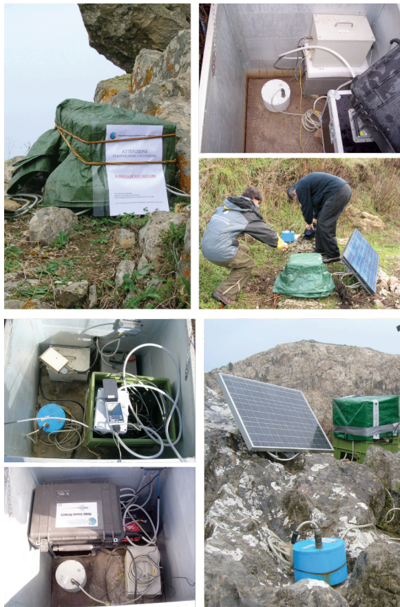
Figura 2 Qualche esempio di stazione sismometrica temporanea.
