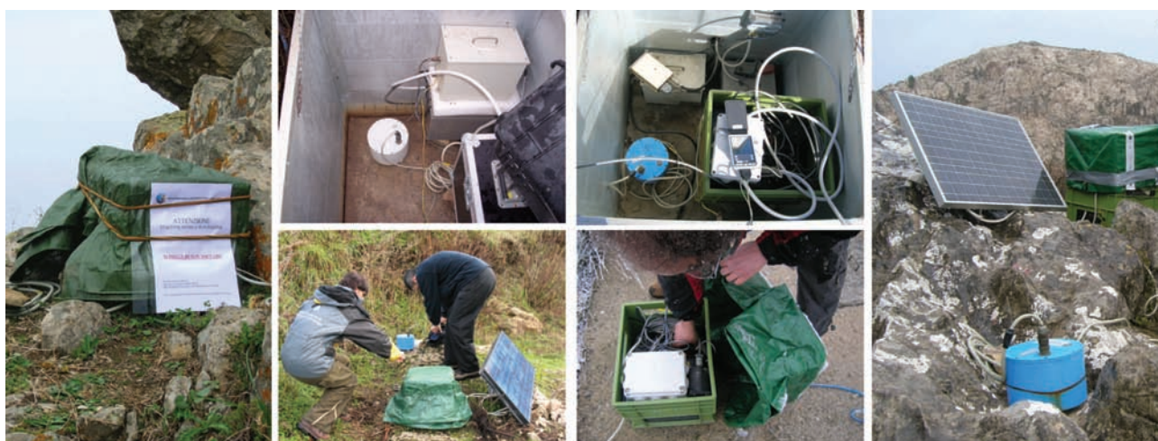
Figura 4 Esempi d’installazione di stazioni sismiche temporanee durante il progetto “Messina 1908-2008”. Figure 4 Some temporary stations installed during the “Messina 1908-2008” project.
