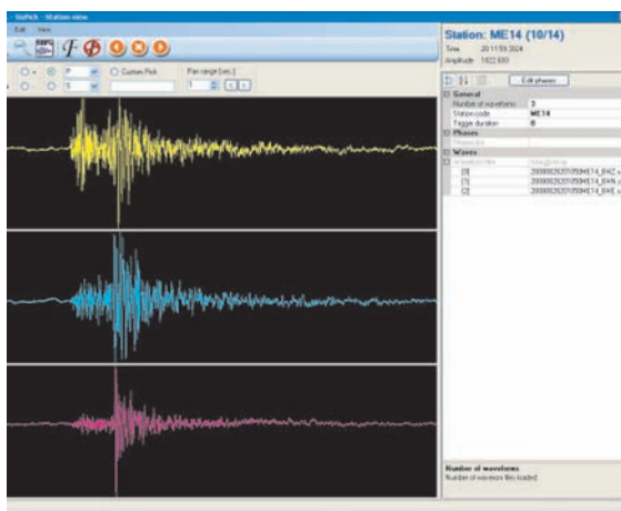
Figura 15 Prime analisi dei dati acquisiti durante la campagna sismica “Messina 1908–2008”. In alto: segnali sismici visualizzati con l’applicazione SisPick! 2.0 . In basso a sinistra: evento registrato dalla stazione temporanea ME14. In basso a destra: evento registrato dall’OBS A3.
