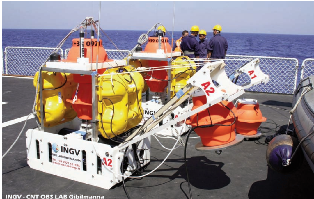
Figura 5 Un OBS/H realizzato presso l’Osservatorio di Gibilmanna - CNT. Figure 5 One of the OBS/H built by the Osservatorio di Gibilmanna - CNT staff.
