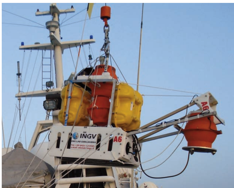
Figura 7 Uno degli OBS/H durante la deposizione nella campagna “Messina 1908-2008”. Figure 7 The INGV OBS/H ready for deployment.
